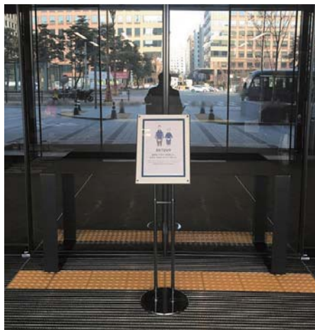
관광숙박시설의 주출입구 자동문을 차단해 시각장애인이 충돌할 위험이 있음.
